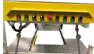
Panneau de contrôle - démarrage/stop - Arrêt d'urgence - Direction du tapis - Interrupteur à LED - Commande manuelle ou au pied - Avance ou retour - Levage ou abaissement
